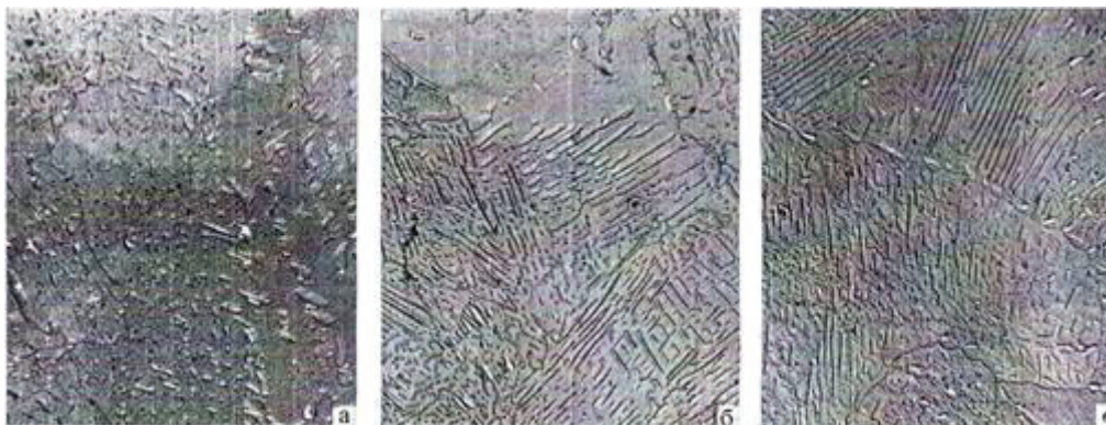
Рисунок 1 – Электронные микрофотографии структур колесной стали в различных слоях от поверхности катания, термически обработанного с прерывистым охлаждением, \times 1200 ; а) на глубине 5 мм; б) на глубине 15 мм; в) на глубине 30 мм
