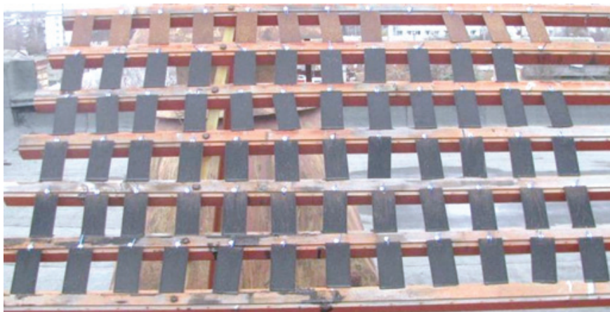
Рисунок 1 – Испытания защитных составов на атмосферостойкость
