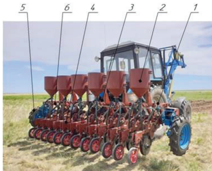
Рисунок 1 — Макетный образец сеялки для посева несypучих семян трав: 1 — рама; 2 — семенной ящик с высевальными аппаратами; 3 — навесное устройство; 4 — посевная секция; 5 — ходовая часть; 6 — привод высевальных аппаратов.
