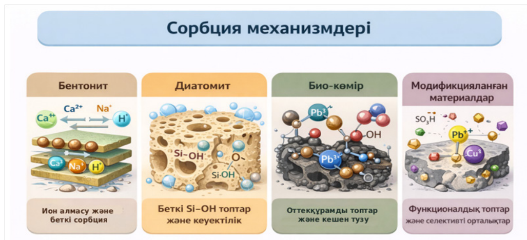
2-сурет – Әртүрлі сорбенттерде \text{Th(IV)} байланысуының негізгі механизмдері
