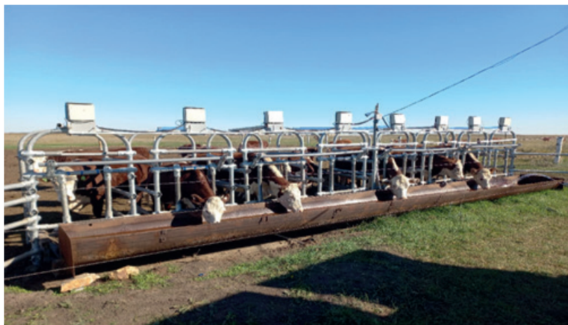
2-сурет – Жайылымда орнатылған өңдеу функциясы бар сегіз автоматты стрессіз өлшеу платформасы
