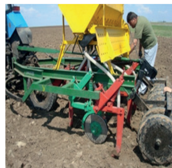
Рисунок 3 – Экспериментальная установка сеялки с дисковыми, чизельными сошниками
