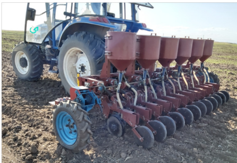
Рисунок 4 - Экспериментальный образец сеялки для посева несypучих семян трав
