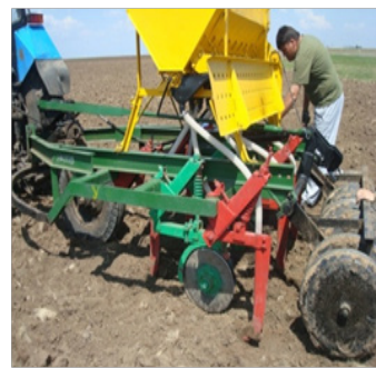
Рисунок 3 - Экспериментальная установка сеялки с дисковыми, чизельными сошниками
