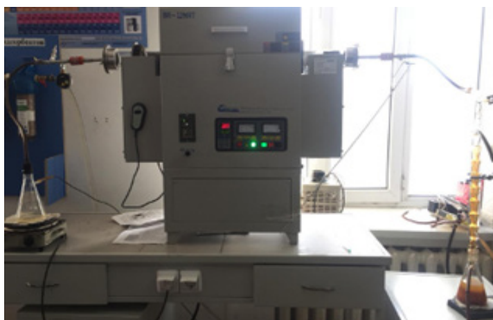
Рисунок 1 – Лабораторная роторная вращающаяся высокотемпературная печь BR-12NRT для процесса карбонизации и активации
