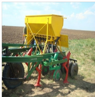
Рисунок 2 - Экспериментальная установка сеялки с дисковыми и культиваторными сошниками
