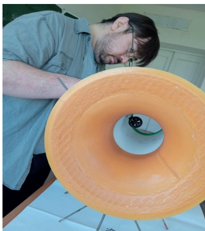
Рисунок 5 – Установка мини-анемометра в канал критики ветроэнергетической установки
