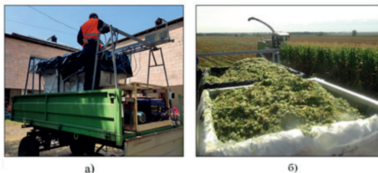
Рисунок 2 – Процесс комплектования агрегата необходимым оборудованием (а), полевые исследования предлагаемого алгоритма операций для заготовки силоса в вакуумированных контейнерах из воздухонепроницаемой пленки (б)
