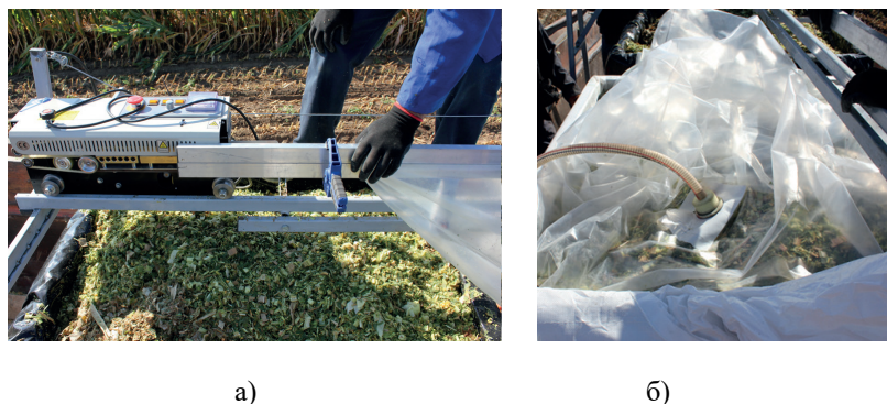
Рисунок 3 – Процесс сваривания горловины контейнера на прицепе (а), подключение вакуумного насоса к контейнеру через клапан (б)
