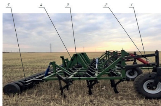
1- опорное колесо; 2- механизм подъема опорного колеса; 3- правая секция; 4- механизм подъема транспортного колеса; 5-катки.
