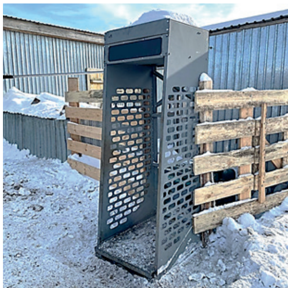
Рисунок 1 – Платформа бесстрессового взвешивания
