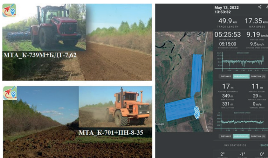
Рисунок 5 – Рабочие моменты хронометража работы мобильного агрегата на обработке почвы: слева показано МТА, справа – записи GeoTracker с указанием участков обработки
