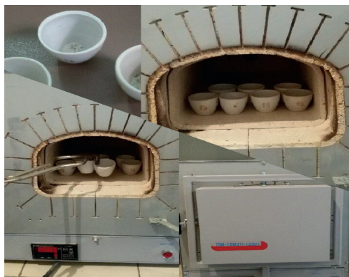
Определение содержания зольности в зерне и муке в муфельной печи ПМ-12
