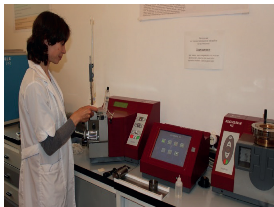
Определение удельной работы деформации теста (силы муки) на альвеографе
