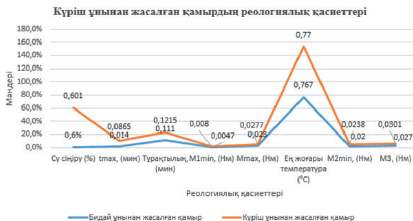
Сурет 2 – Күріш ұнынан жасалған қамырдың реологиялық көрсеткіштері
