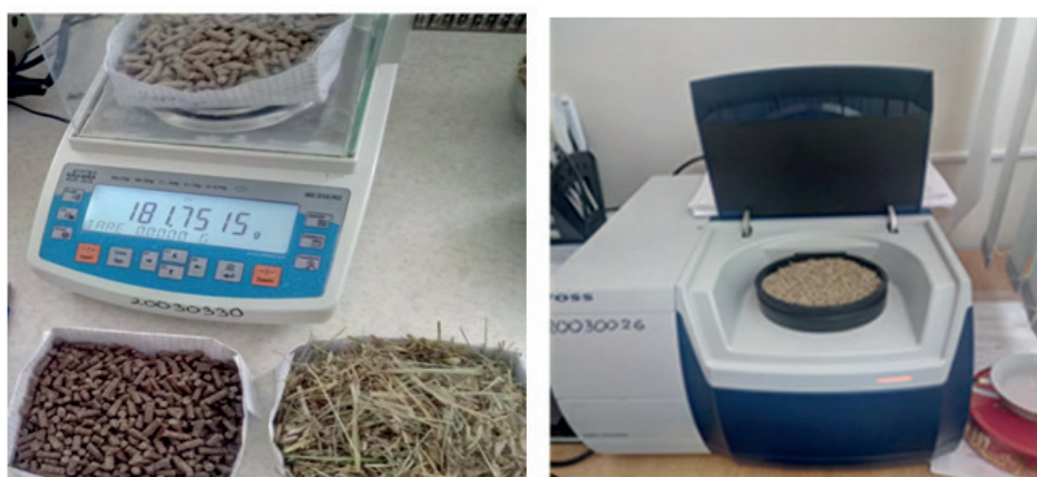
Сурет 3- FOSS құралын пайдалану арқылы азықтың химиялық құрамын анықтау барысы
