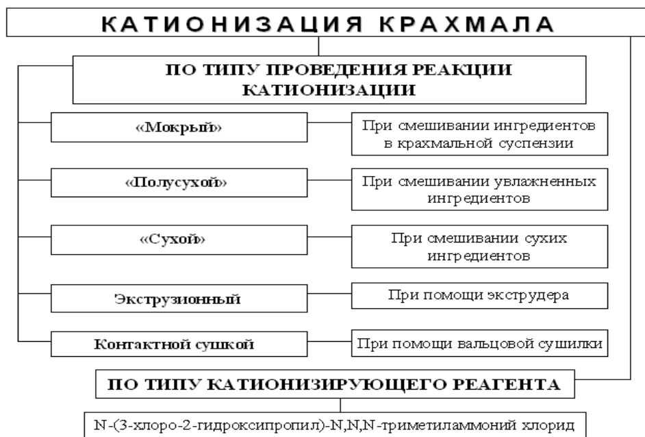
Рисунок 1 – Классификация способов катионизации крахмала
