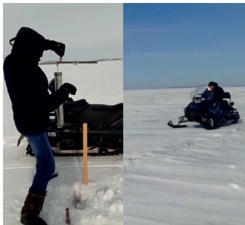
Рисунок 1 - Процесс измерения высоты снега металлической линейкой и плотности снегомером VS-43 на снегоходе для удобного и быстрого передвижения
