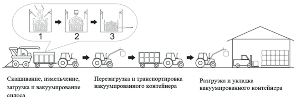
Рисунок 2 – Операции, входящие в технологию приготовления и хранения силоса в мягких вакуумированных контейнерах путем вакуумирования
