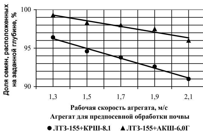
Рисунок 2 – Распределение семян сахарной свеклы на установленной глубине заделки после предпосевной обработки почвы агрегатами ЛТЗ-155+КРШ-8,1Г и ЛТЗ-155+ АКШ-6Г
