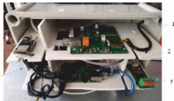
Рисунок 6 – Внутренняя компоновка электронного блока
