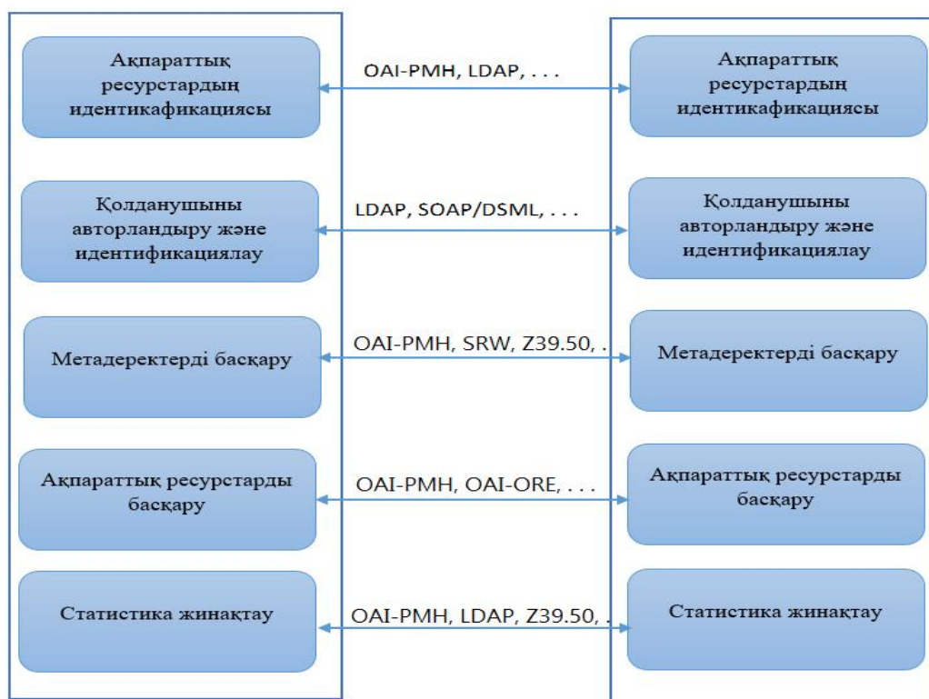
1-сурет. Таратылған ақпараттық жүйелердің ішкі жүйелерінің өзара желілік байланысу хаттамасы
