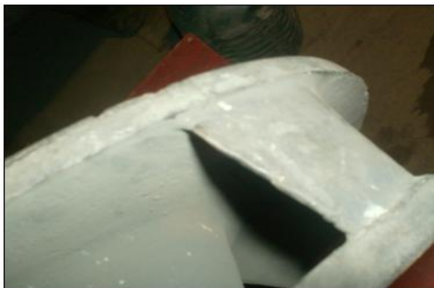
Рисунок 4 – Рабочее колесо насоса из полиуретана
