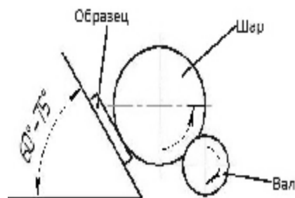
Рисунок 4 - Схема расположения образца относительно шара и приводного вала
