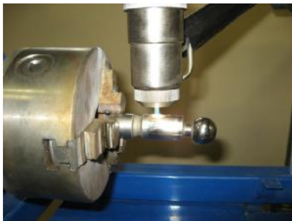
Рисунок 1 – Процесс обработки плунжера топливного насоса плазменной струей с нанесением тонкопленочного покрытия
