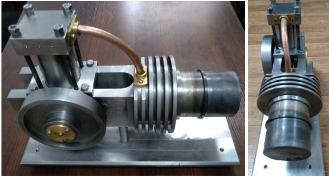
Рисунок 2 - Исследуемый двигатель с внешним подводом тепла типа «Гамма»
