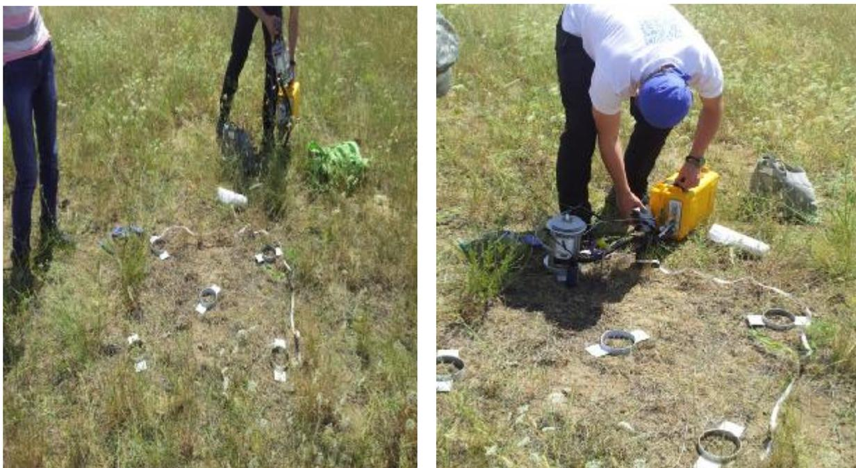
Рисунок 2. Процесс измерения эмиссии диоксида углерода прибором Li-8100A
