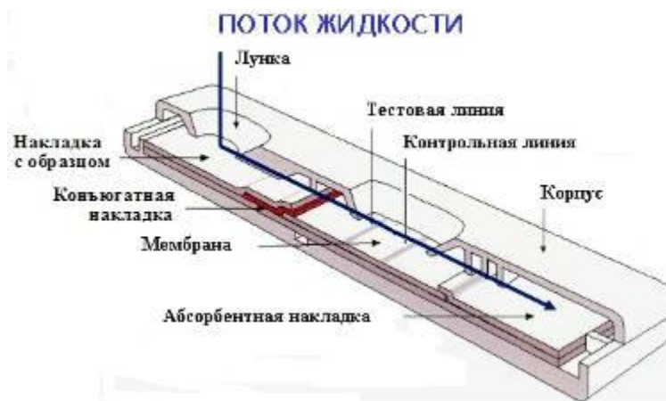
Рисунок 3- Схема устройства иммунохроматографического теста.
