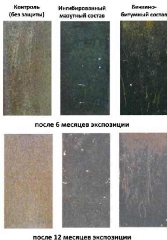
Рисунок 5 – Вид пластин после атмосферных испытаний
