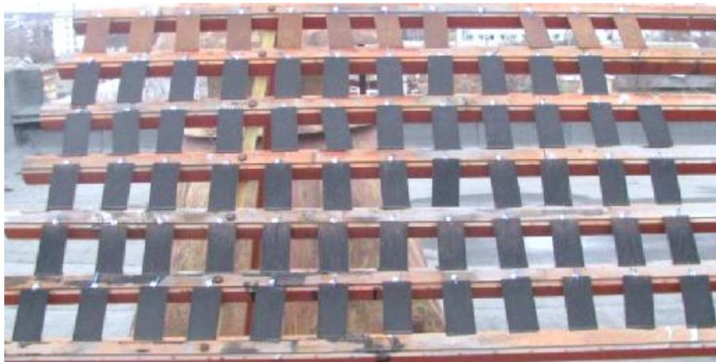
Рисунок 1 – Испытания защитных составов на атмосферостойкость
