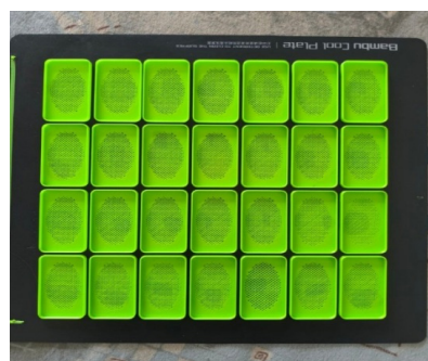
6-сурет – Торды әртүрлі дәрежеде толтыруды сынау
