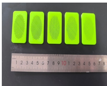
6-сурет – Торды әртүрлі дәрежеде толтыруды сынау
