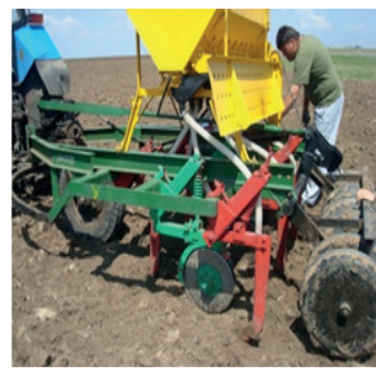
Рисунок 3 - Экспериментальная установка сеялки с дисковыми, чизельными сошниками
