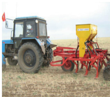
Рисунок 1 - Сеялка для разбросного подпочвенного посева в лабораторно-полевых испытаниях
