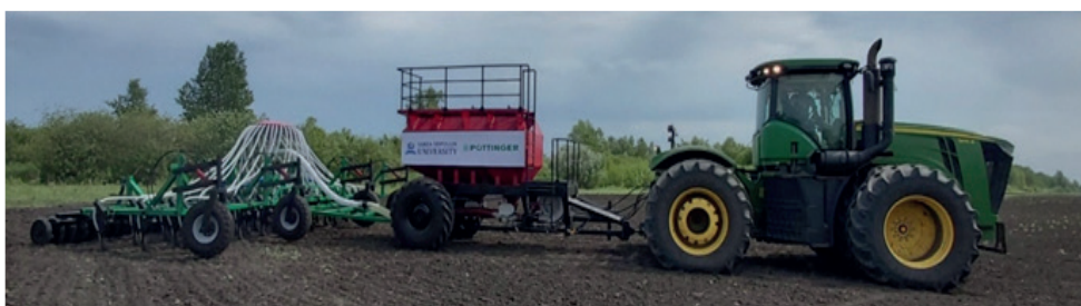
Рисунок 5 - Широкозахватная сеялка для посева зерновых культур с интеллектуальным блоком управления
