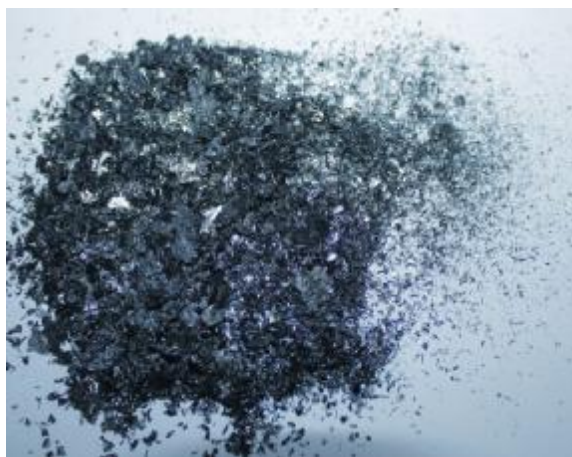
Сурет 1. Балқу жолымен алынған аморфты және шиша-кристаллды материалдар
