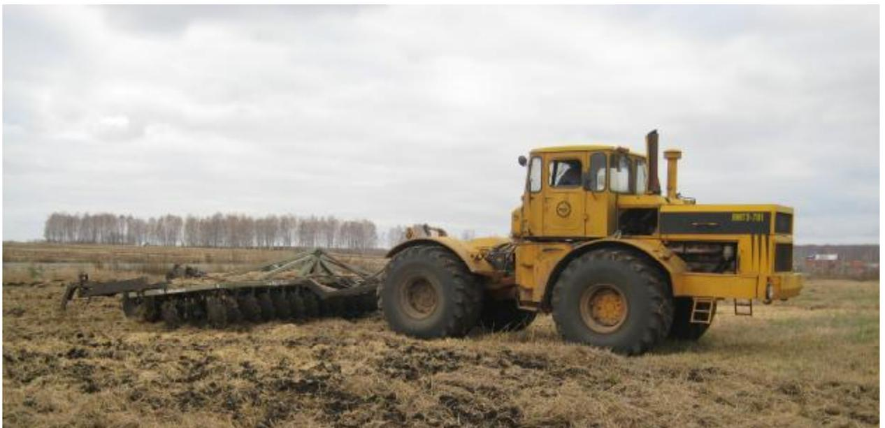
Рисунок 8 - Экспериментальный агрегат К-701+ПД БДМ-6x4
