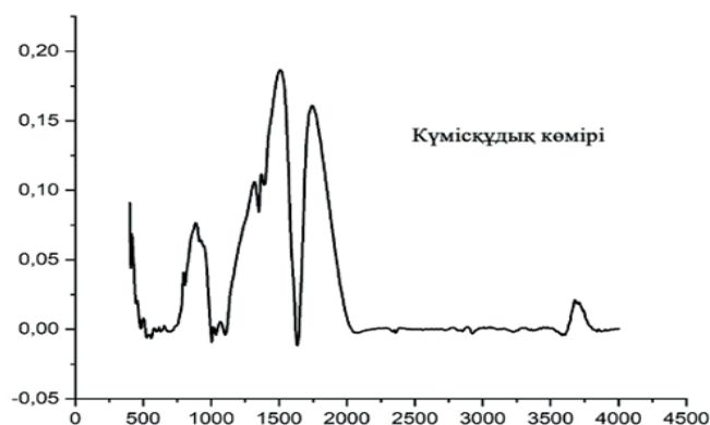
4-сурет – Көмір үлгілерінің ИК-спектрлері
