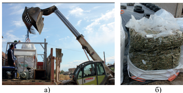
Рисунок 4 – Выгрузка вакуумного блока с измельченной массой (а) вакуумированный контейнер готовый для хранения (б)
