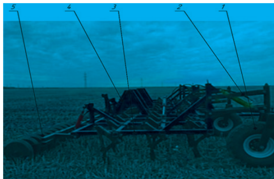
1- опорное колесо; 2- механизм подъема опорного колеса; 3- правая секция; 4- механизм подъема транспортного колеса; 5-катки.
