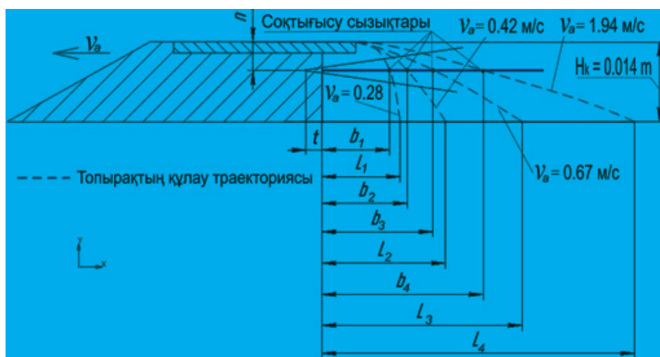
4-сурет – Түрлі жылдамдыққа сай топырақ бөлшектері мен бүркілген сұйықтың соқтығысу қашықтығы
