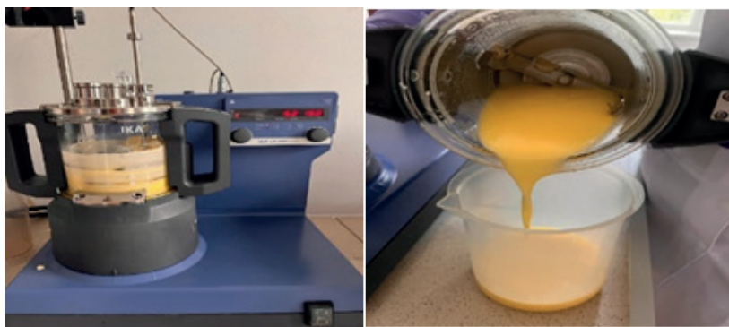
1-сурет - IKA LR 1000 basic base лабораториялық реактор көмегімен эмульсия алу барысы
